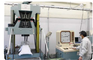
鉄筋引き抜き試験の様子 (公財)大分県建設技術センター
