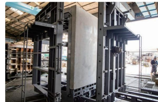
高精度かつ簡単に開け閉めできる鋼製型枠。木製型枠と違い10年以上の耐用年数。
