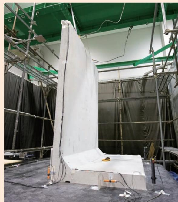
日本初のプレキャストコンクリート塀 実物大耐震振動実験
