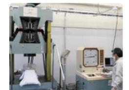
鉄筋引き抜き試験の様子
